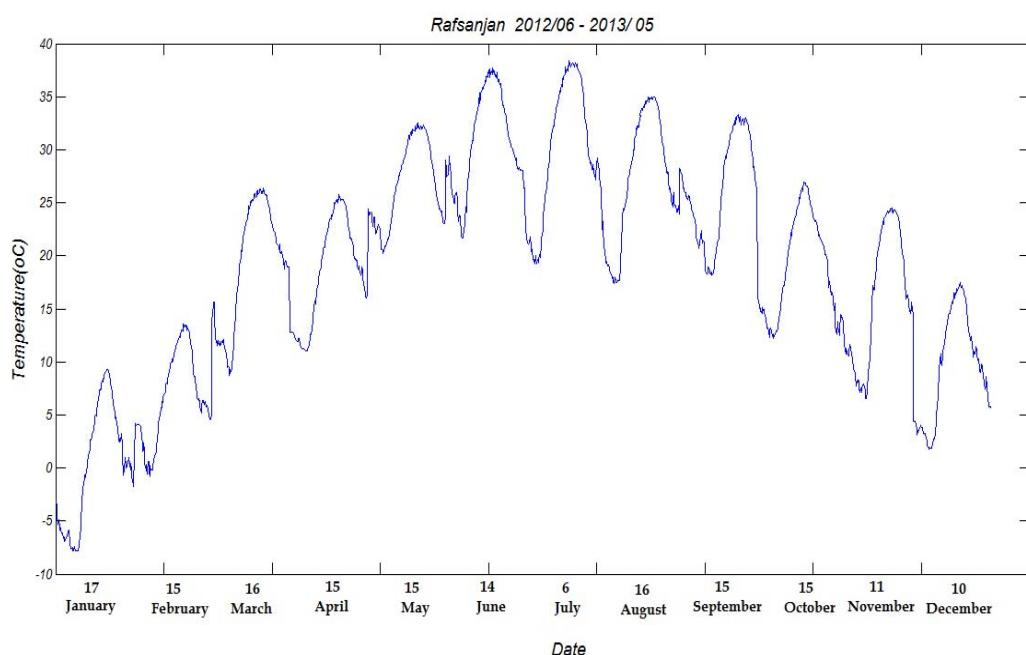
شکل ۵) دمای محیط اندازه گیری شده توسط دماسنچ ایستگاه سینوپتیک شهر رفسنجان برای یک روز از هر ماه
